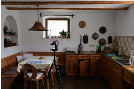
Aufmaß mit Leica Disto X4
