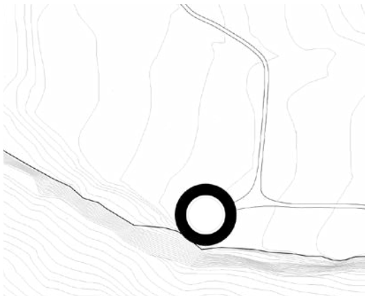
Lageplan · Konzentration des Baukörpers entlang der Hangkante
